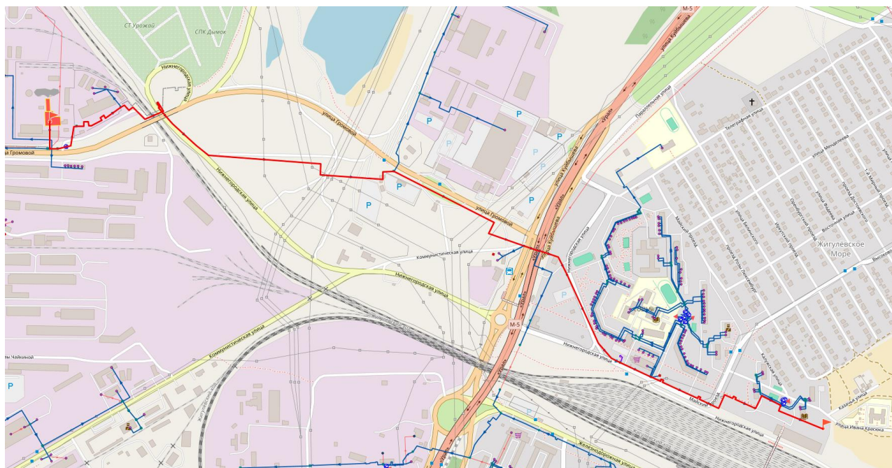
Рисунок 3.5 – Трассировка теплопровода от Котельной №2 до потребителя «Д/с №125 «Росточек»»
